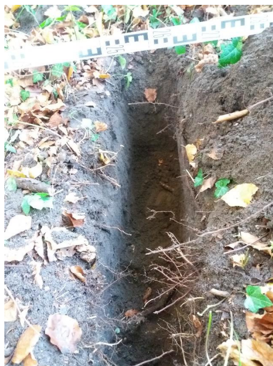
Figuur 18 Proefsleuf met bovenin enkele dunnere wortels en op diepte van 35 cm dikke wortels.
