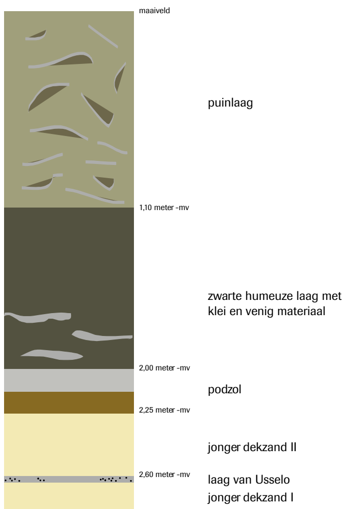
Afb. 1. Bodemopbouw onder de vesting.
