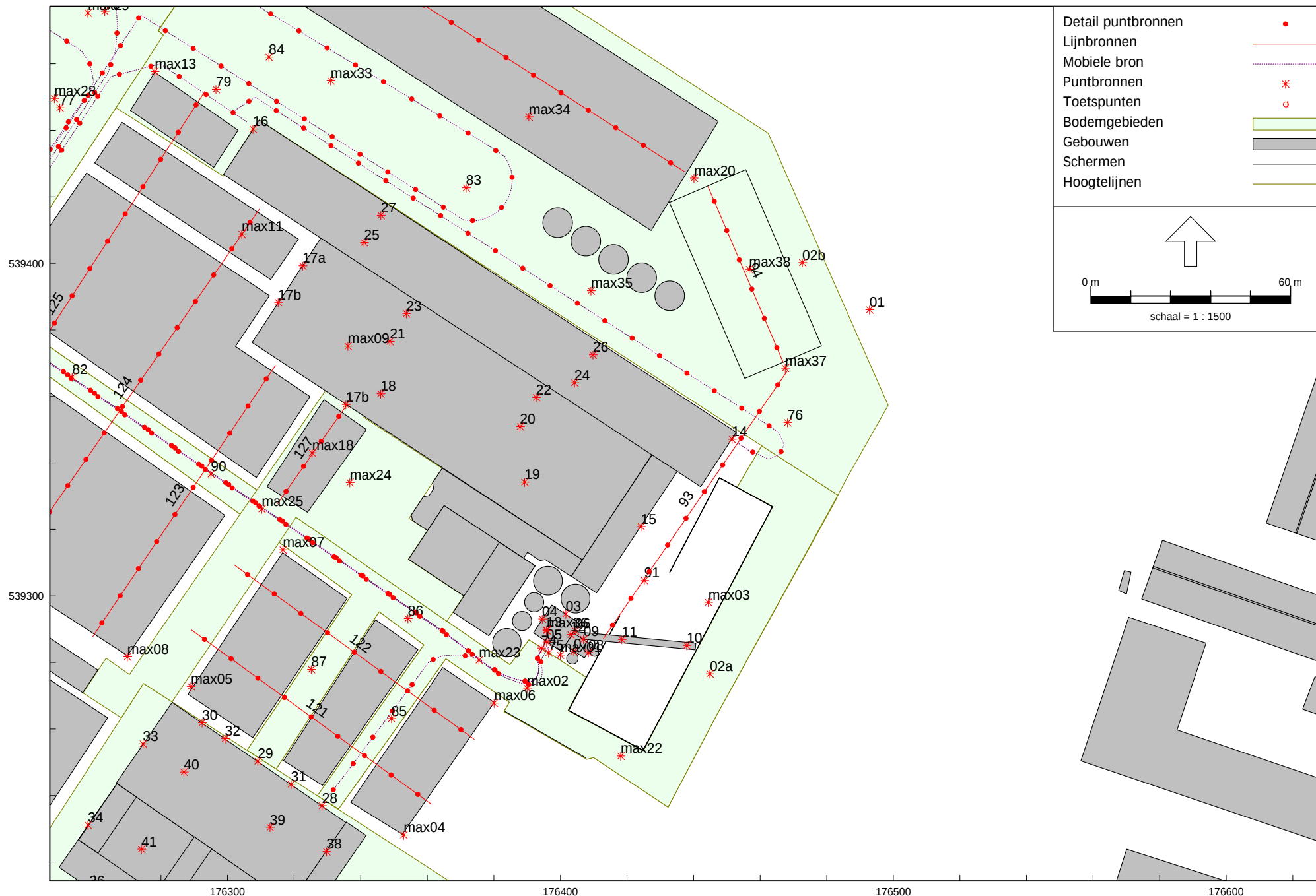
Detailoverzicht van het rekenmodel, met de ligging van de voor IJB in het model opgenomen geluidbronnen.
