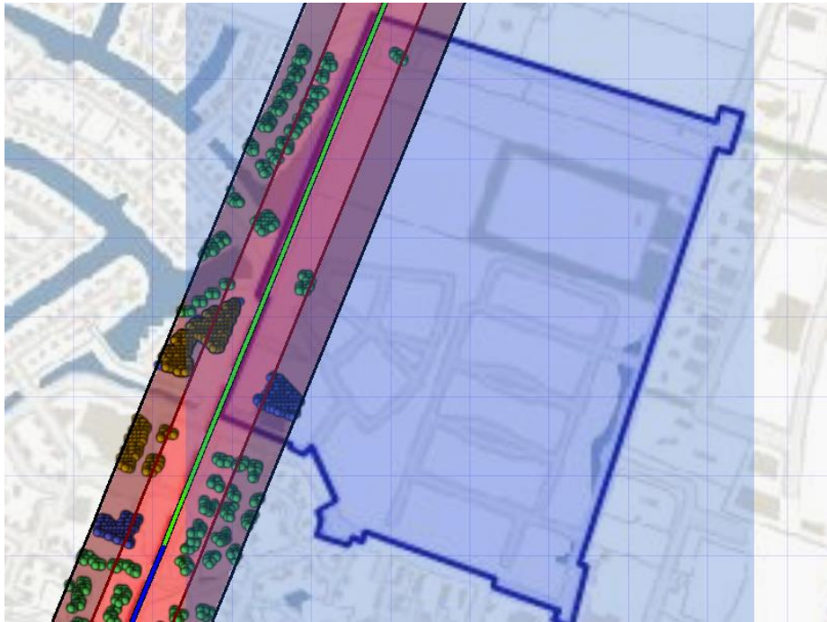
Figuur 5: deel van aardgastransportleiding N-501-26 waar een GR is berekend
