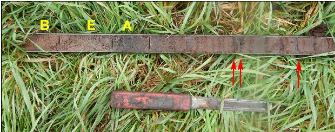
Afbeelding 18. Foto van de top van het dekzand en de basis van het veen in boring 7. In de top van het dekzand is een podzolprofiel aanwezig (A-, E-, B-horizonten). De pijlen geven de brandlaagjes in het veen aan
