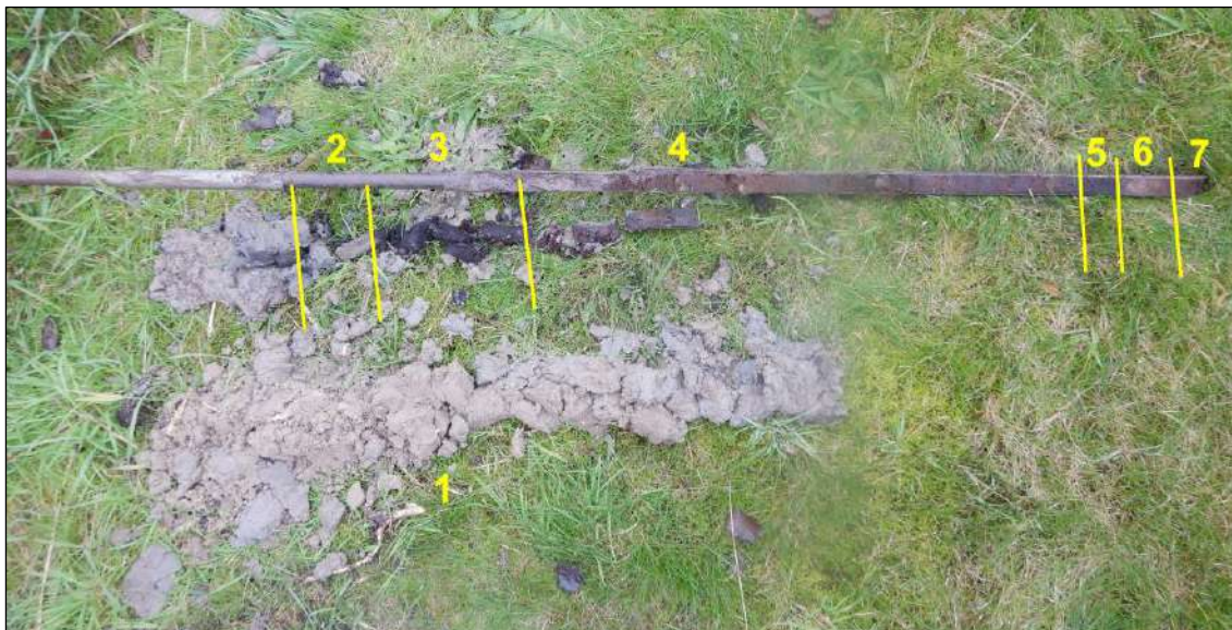
Afbeelding 17. Foto van boring 9. 1: opgebrachte grond, 2: humeuze klei, 3: veraard veen, 4: veen, 5: dekzand, A-horizont, 6: dekzand, E-horizont, 7: dekzand, B-horizont
