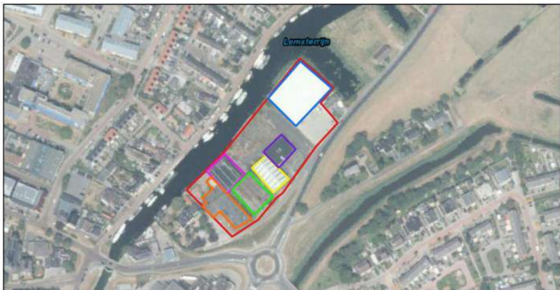
Afbeelding 2.1. Begrenzing van het plangebied (rood kader). Het oranje en groene kader zijn de twee stenen panden, het roze kader is de loods aan het water met houten planken, het blauwe kader is de voormalige bouwmarkt en het gele en paarse kader zijn de loodsen met golfplaten daken (Bron achtergrond: Esri).
