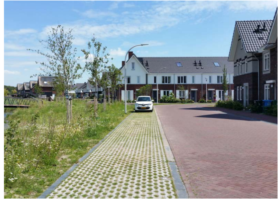
Grasbetontegels voor parkeerplaatsen
