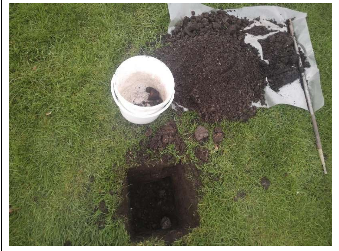
Foto 1. Asbestinspectiegat met opgegraven en gezeefd material 03
