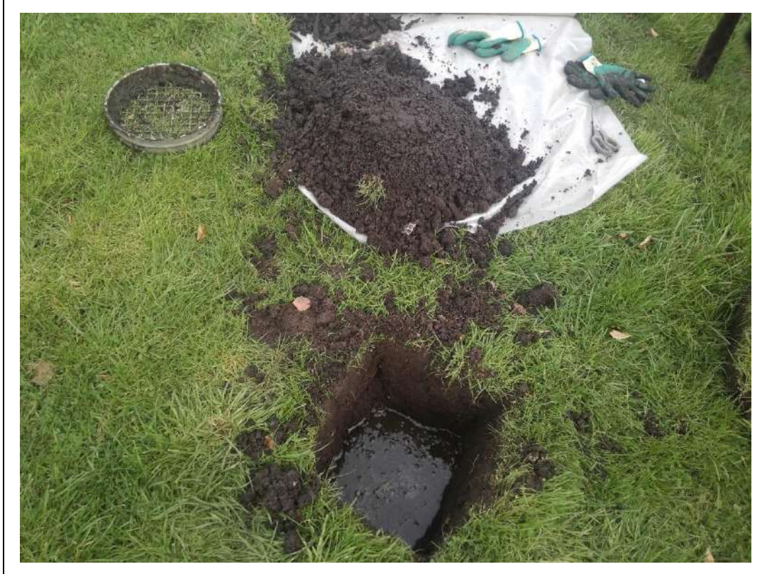
Foto 2. Asbestinspectiegat met opgegraven en gezeefd material 04
