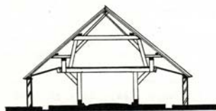
constructie geheel tot dekbalkgebint verzaagd
