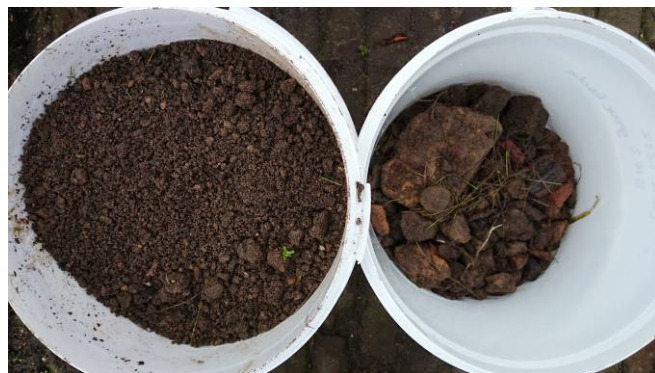
Foto 6: inspectiegat SL14, gezeefd materiaal
