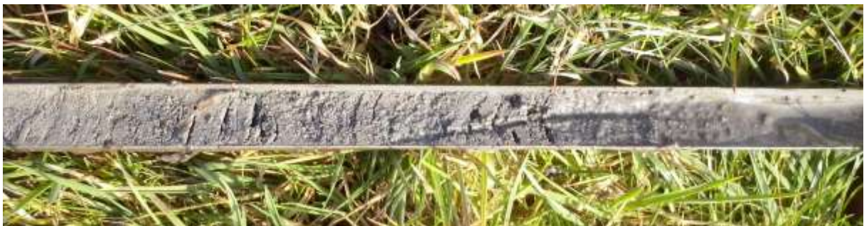
Figuur 14: Foto van boring 1 met de links een afwisseling van klei en zandlaagjes en rechts het grove zand dat uit de guts stroomde.
