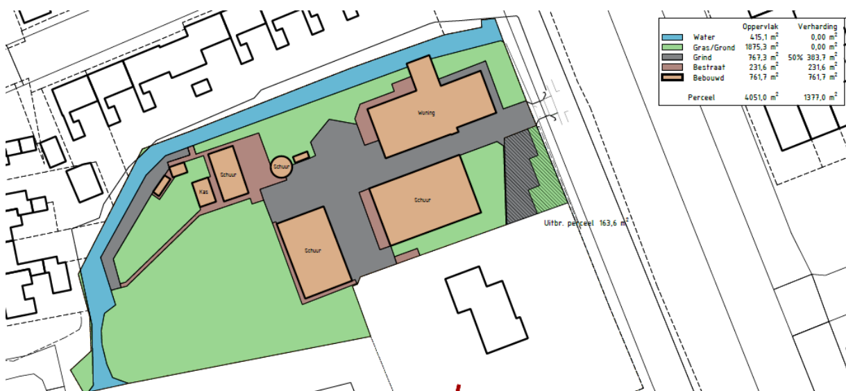
Afbeelding 13: Verharding bestaande situatie
