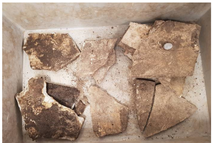
Foto 12: asbestverdacht materiaal SL23
