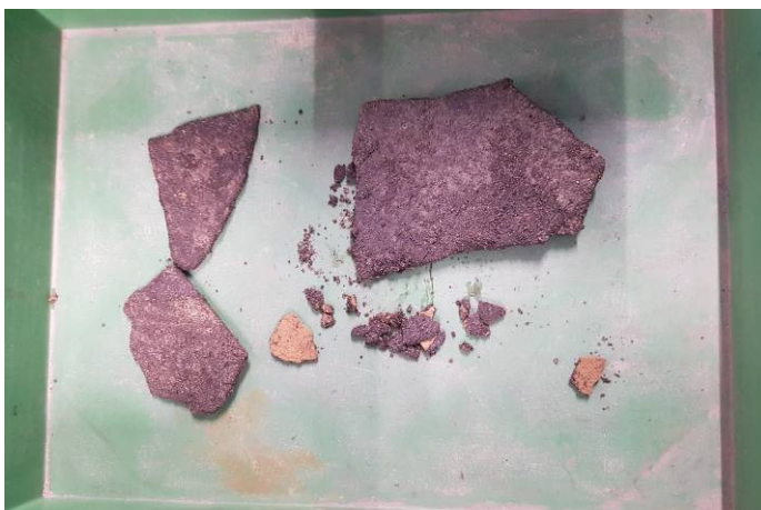
Foto 11: asbestverdacht materiaal SL21
