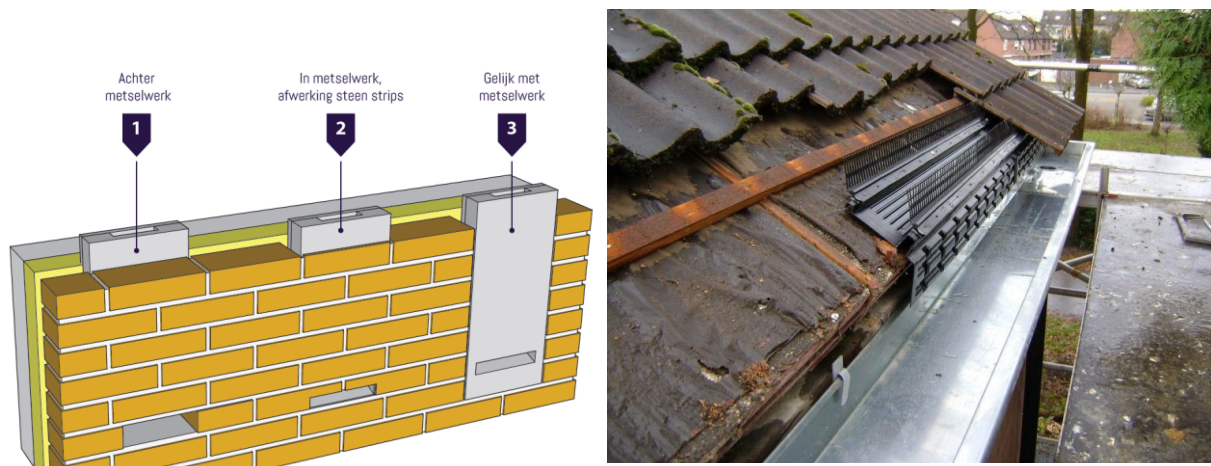
Figuur 18: Inbouwkasten voor vleermuizen (l) en een vogelvide voor huismussen (r).
