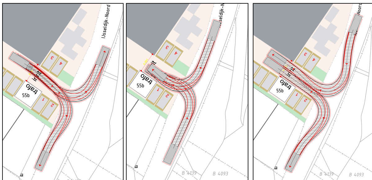
Afbelding 8, 9 en 10; Rijcurves voor het in- en uitrijden van de noordelijke inrit
