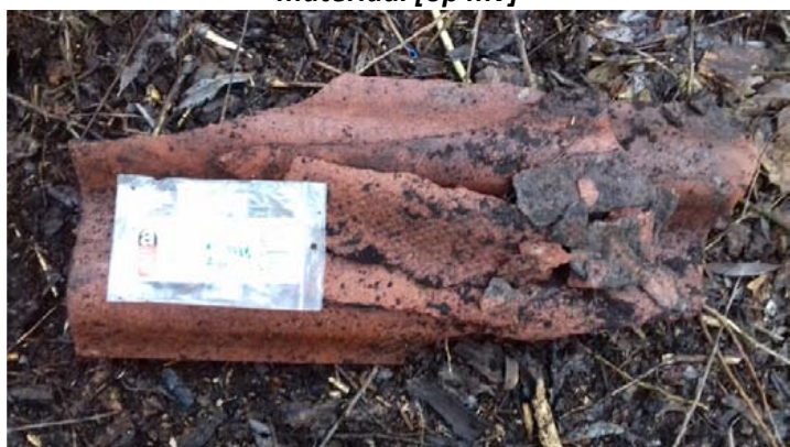
foto 03 - bemonsterd stukje plaat A01 [op mv]
