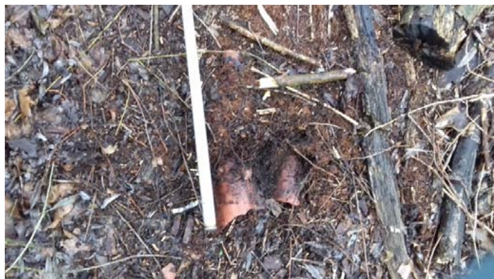
foto 02 - strook met vindplaatsen asbestverdacht materiaal [op mv]
