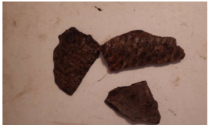
Foto 6: inspectiesleuf SL111 (asbestverdacht materiaal)
