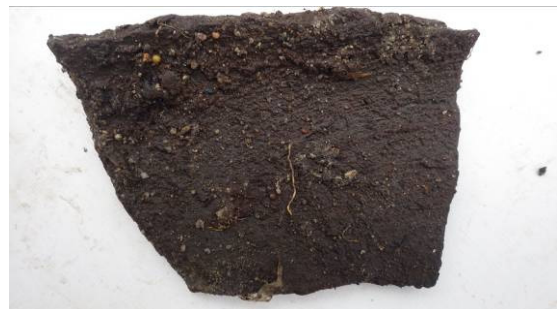
Foto 6: inspectiesleuf SL111 (asbestverdacht materiaal)
