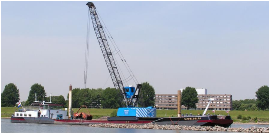
Figuur 3-3: Voorbeeld van een kraanschip met draadkraan [4]
