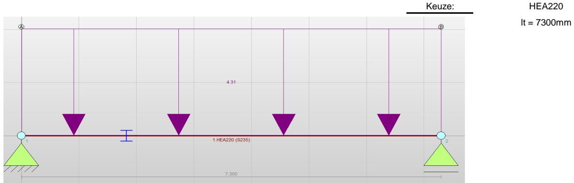
$$\begin{array}{lll} q_{G;k;1} & = 4,1 \cdot 2 \cdot 0,5 \cdot 1,05 & = 4,31 \quad \text{kN/m} \\ q_{Q;k;1} & = 4,1 \cdot 2 \cdot 0,5 \cdot 0,56 & = 2,30 \quad \text{kN/m} \end{array}$$
