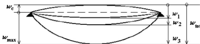
$w_c$  = zeeg van het onbelaste constructief element;
