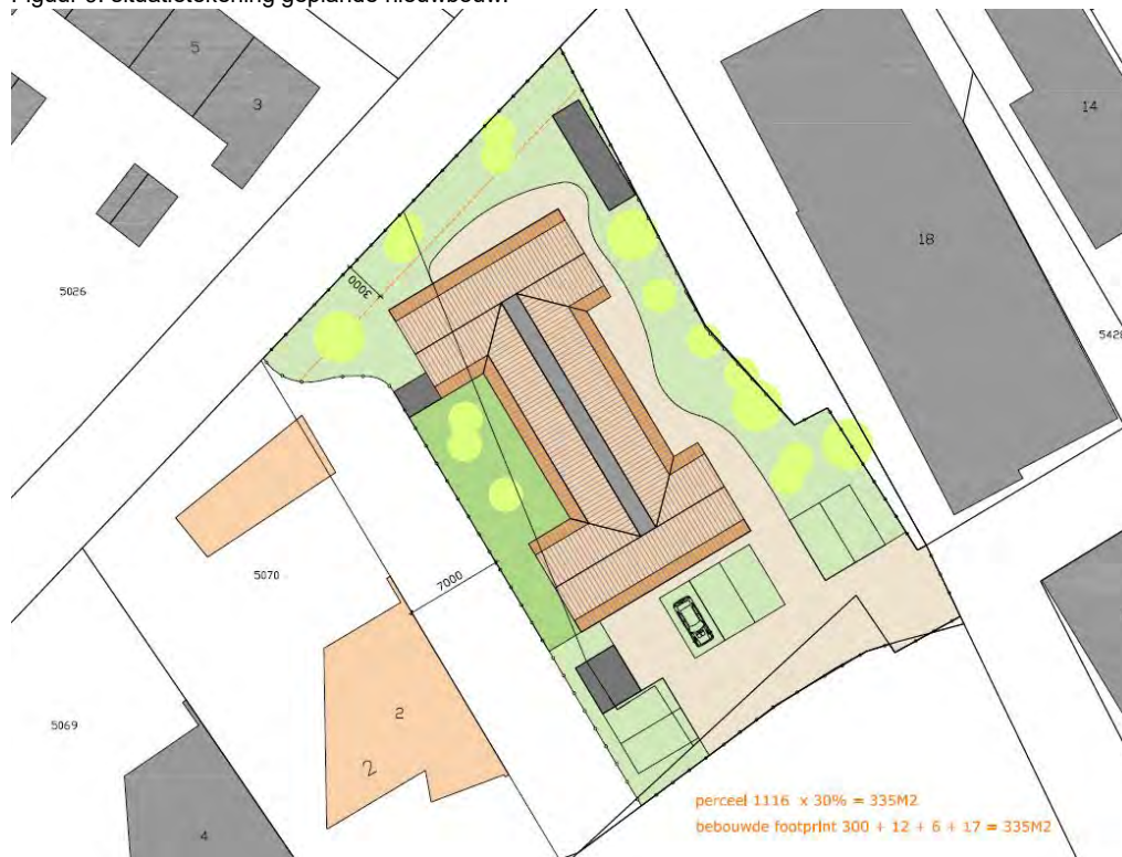
Figuur 9. situatietekening geplande nieuwbouw.
