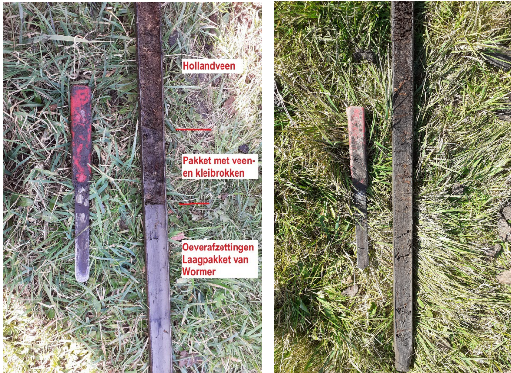
Afb. 4 Links: Boring 106 m een abrupte overgang van het Laagpakket van Wormer naar het Hollandveen waarbij de top van de Wormerafzettingen veen- en kleibrokken bevat. Rechts: Boring 112 met een diffuse overgang van het Laagpakket van Wormer naar het Hollandveen.
