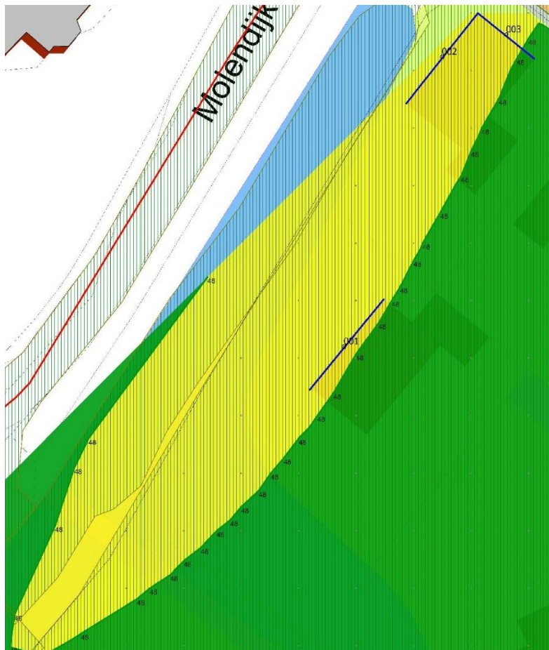
Afbeelding 4.1 Geluidcontouren Molendijk op 7,5 meter hoogte (derde bouwlaag)
