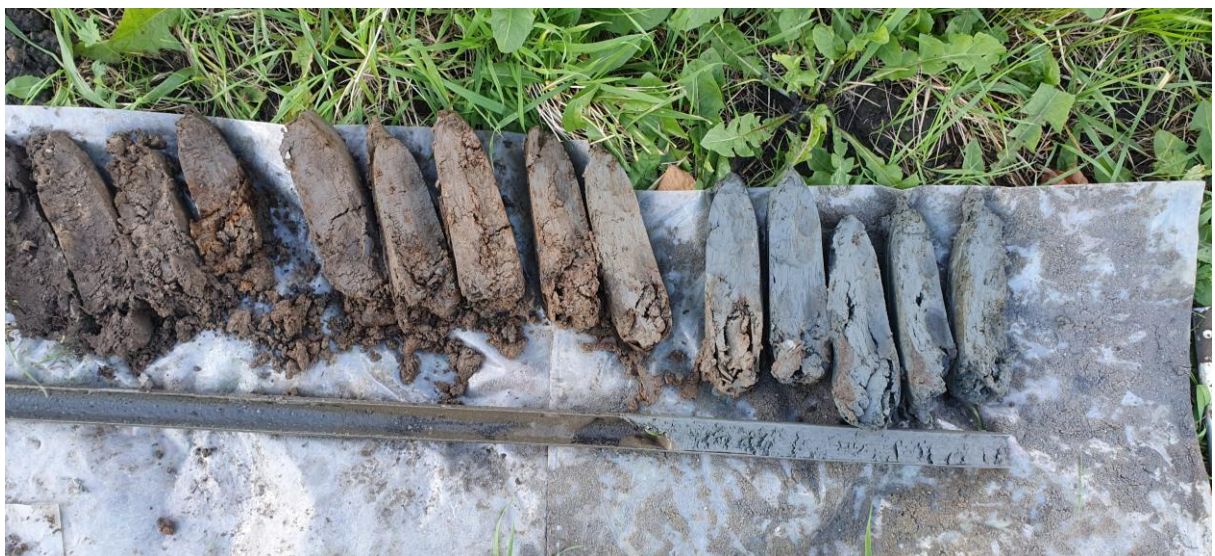
Boring 7. Aandacht voor het donkergrijze/bruinigrijze roestige traject op 70 cm (per 50 cm) uitgelegd. Gefotografeerd is het traject tot 2,0 m -Mv.
