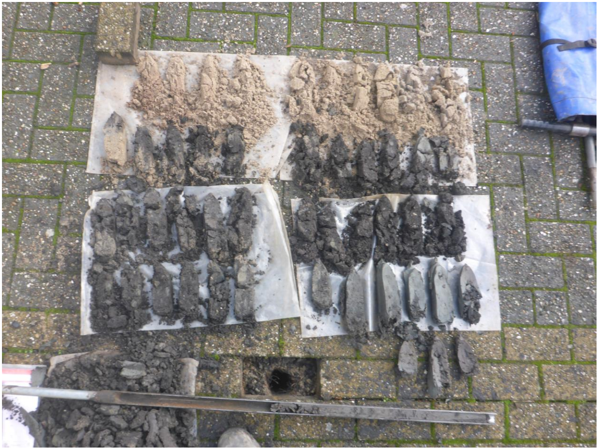
Boring 3, per 50 cm blokjes uitgelegd. De klei was te hard voor gutswerk. Daarom is met een Edelman geboord, waarvan de kernen werden afgesneden.
