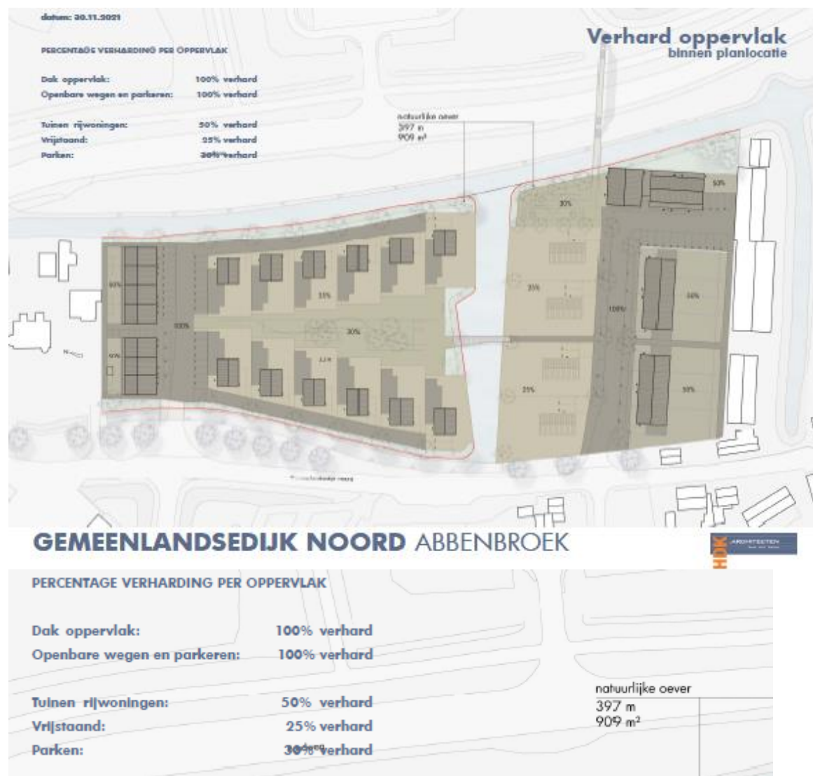
Figuur 4.5: berekening verhard oppervlak met uitvergroting cijfers
