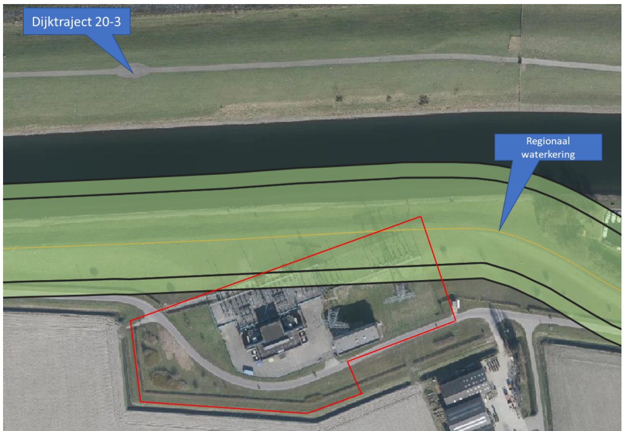
Figuur 3-8 Overzicht regionale en primair waterkering in het nabij van het plangebied (bron: Legger waterkeringen, waterschap Hollandse Delta, legger RWS).
