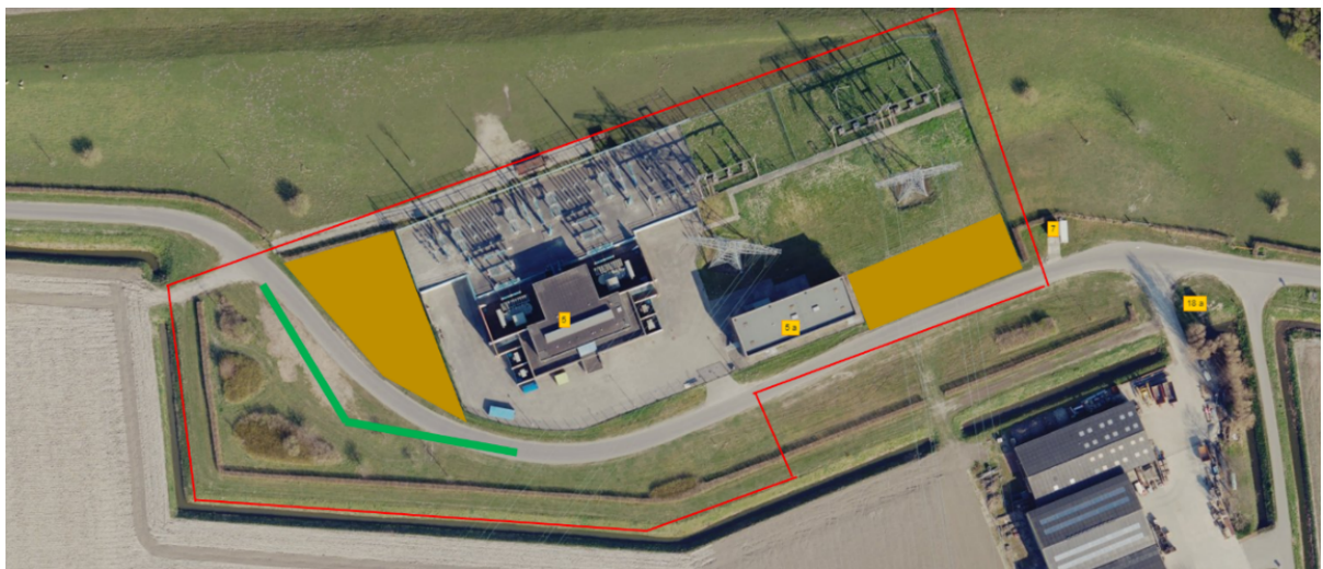
Figuur 5-1 Overzicht van de verwachte toename verharding (worst-case-scenario). De voorgestelde locatie van de weg wordt aangegeven met een groene lijn
