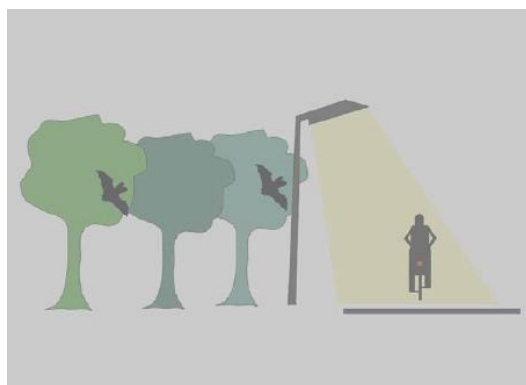
Figuur 5.2. Links: amberkleurige UV-vrije LED-armatuur. Rechts: scherpe afsnede van lichtinval.
