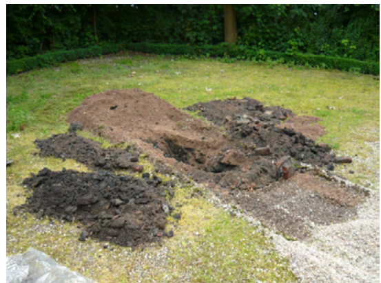
Foto 47 SL05 sterk puinhoudende grond en gravel
