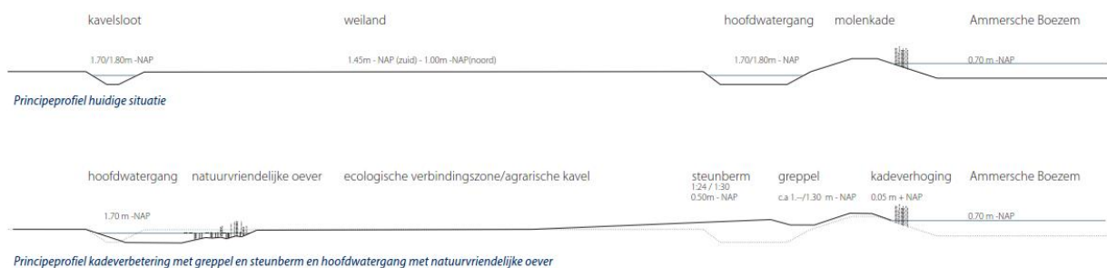
Figuur 4: Principeprofielen huidige en toekomstige situatie (bron: Uitwerking inrichtingsplan Molenkade Groot-Ambers, Grontmij, 2015)
