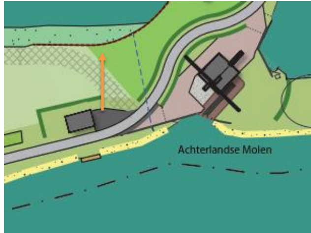
Figuur 11: Indicatie locatie constructie ten behoeve van stabiliteit tussen steunberm en watergang in verlengde Peppelweg (links) en langs moestuin bij Achterlandse molen (rechts)
