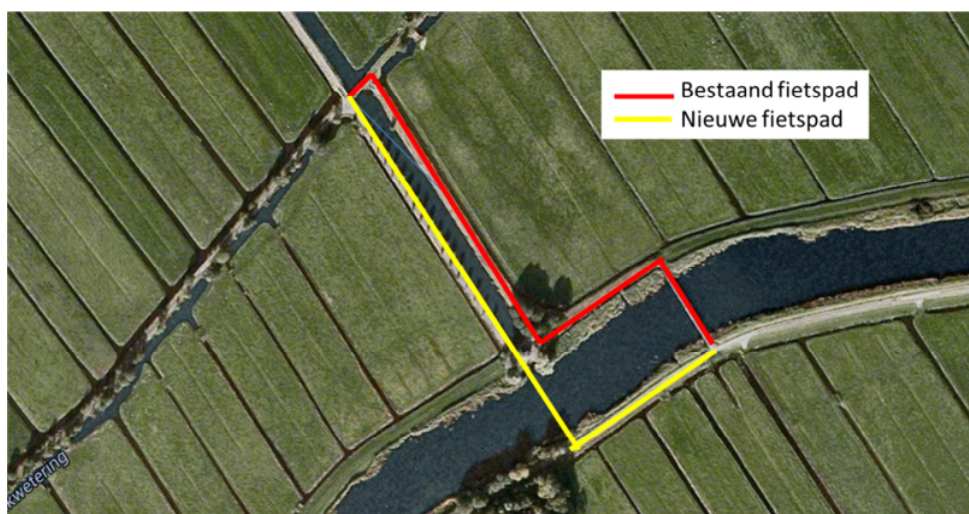
Figuur 1 Overzicht verlegging fietspad
