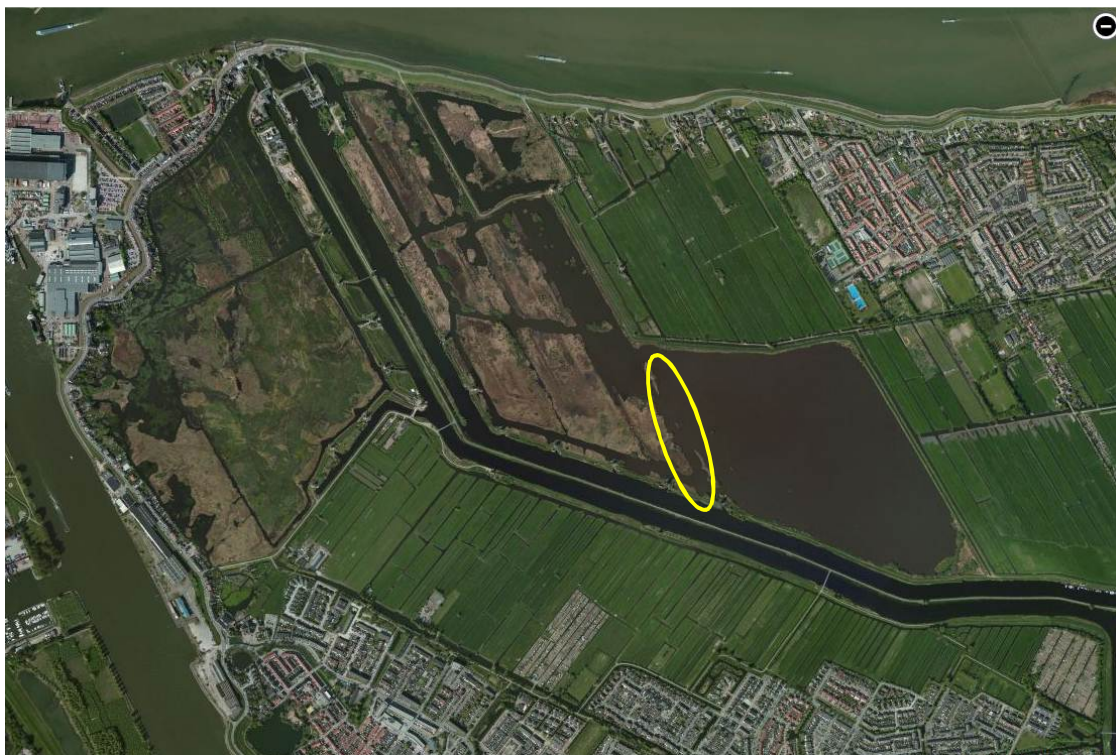
Figuur.5.1 Luwtestructuur in de Hoge van de Overwaard om de golfploop richting de rietgorzen te dempen.
