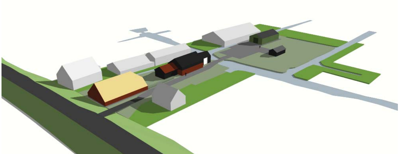
Afbeelding 12: bebouwing op het perceel staat in 1 lijn; de nieuwe schuur sluit aan op de afmetingen van het naastgelegen bedrijfsgebouw; de kleuren van de nieuwbouw passen in het landschap
