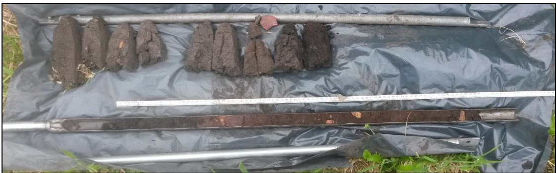
Figuur 3 De antropogene ophoging (donkergrijs) in boring 1, met daaronder het veen (bruin) met daarin een laatmiddeleeuwse bouwvoor (zwart).
