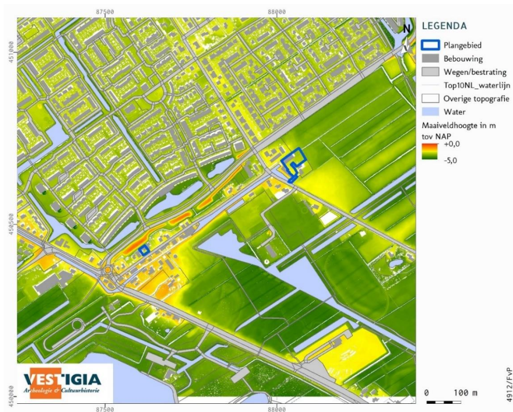
Afbeelding 6 Uitsnede van het plangebied Geerweg (links) en Laakweg (rechts) op het Actueel Hoogtebestand Nederland (AHN-3; 50cm grid). Bron: www.ahn.nl .
