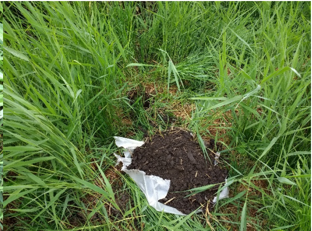
Foto 6: Proefgat A01, onderzoek asbest in grond
