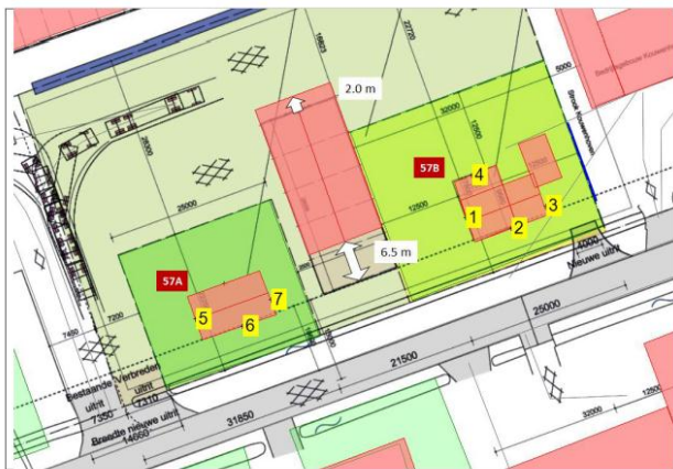
Figuur 4 Advies minimale afmetingen bedrijfsgebouw vanuit akoestisch oogpunt.
