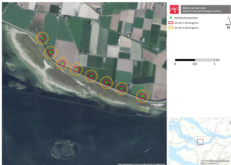
Figuur 13 – Risicocontouren van de Bovengrens en kwetsbare objecten
