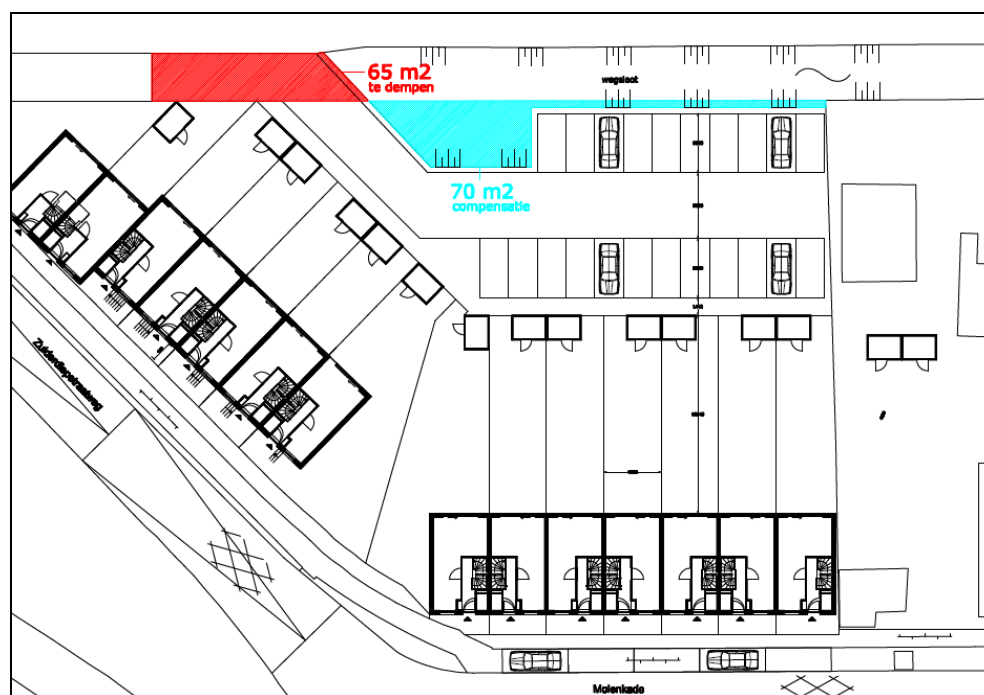
Figuur 9: Op de tekening is het te dempen en te graven water aangeduid.
