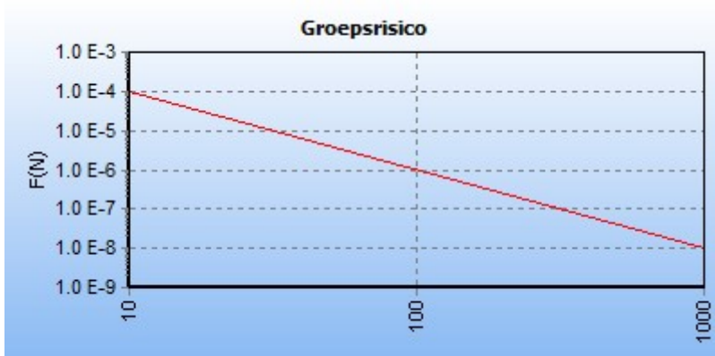
5.2 Figuur 5.2 FN curve voor 7078_leiding-W-538-26-deel-1 van N.V. Nederlandse Gasunie voor de kilometer tussen stationing 2150.00 en stationing 3150.00
