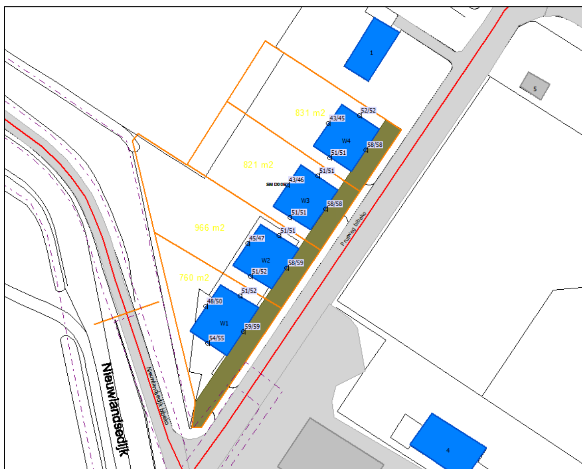
Figuur 4.4: Rekenresultaten gecumuleerde geluidbelasting vanwege wegverkeerslawaai, zonder aftrek
