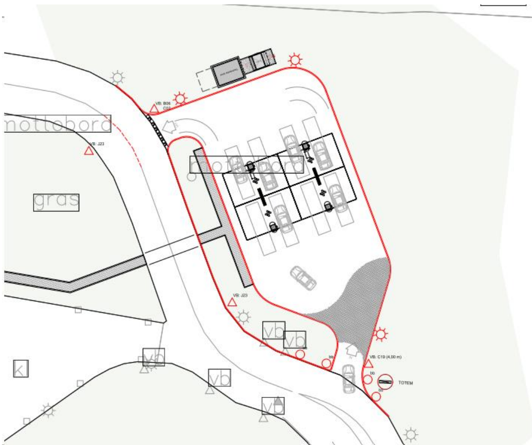
Figuur 2.2. schematische weergave van de toekomstige situatie (bron: Fastned)
