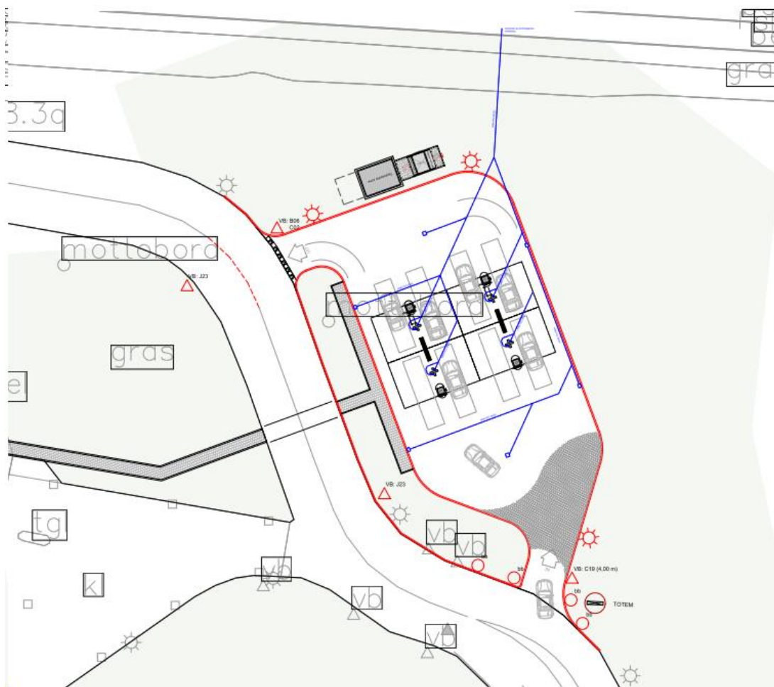
Figuur 4.4 Schematische weergave hemelwaterafvoer
