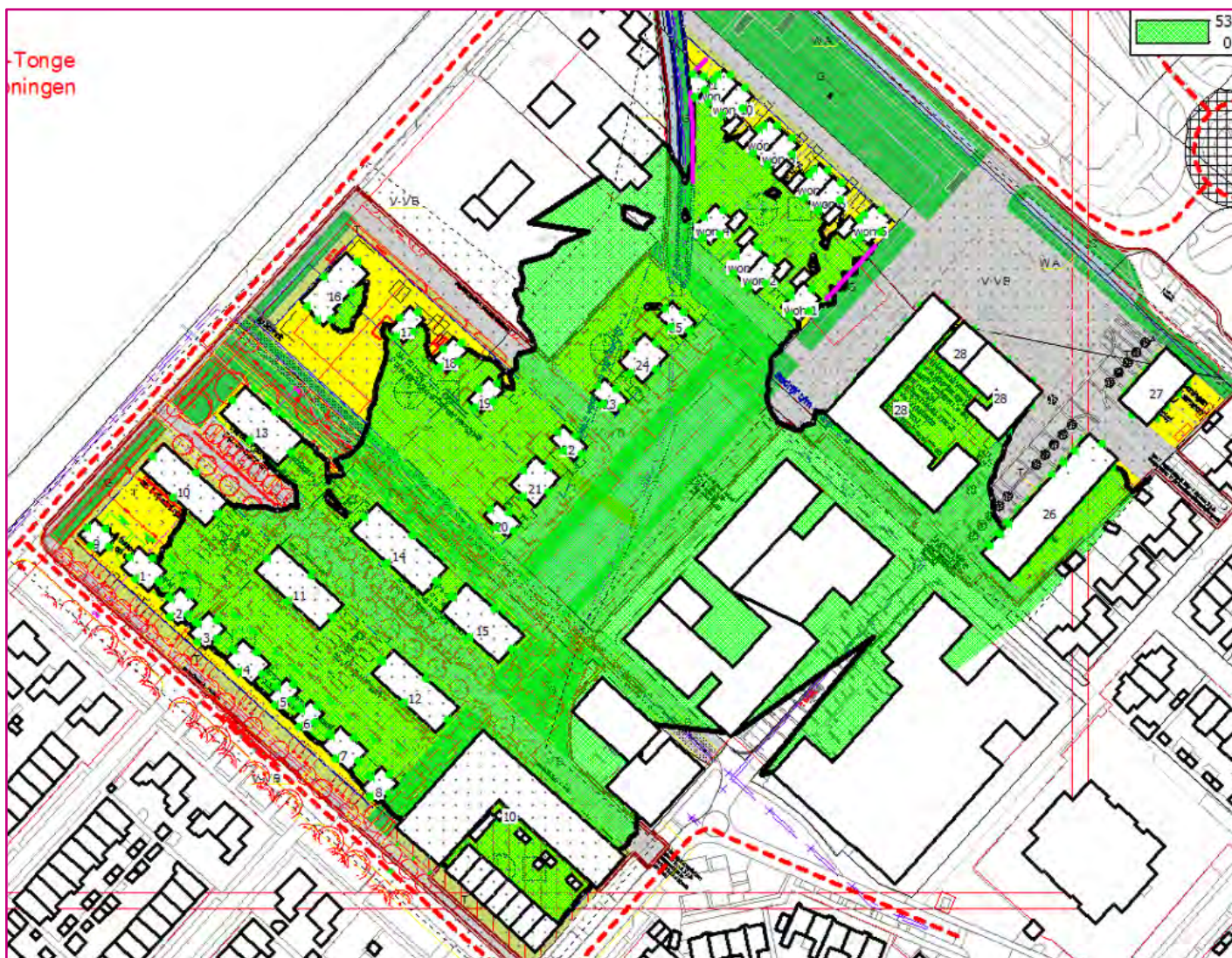
Figuur 5.19 Gecumuleerde geluidbelasting alle wegen samen, exclusief aftrek artikel 110g Wgh, toetshoogte 1,5 meter
