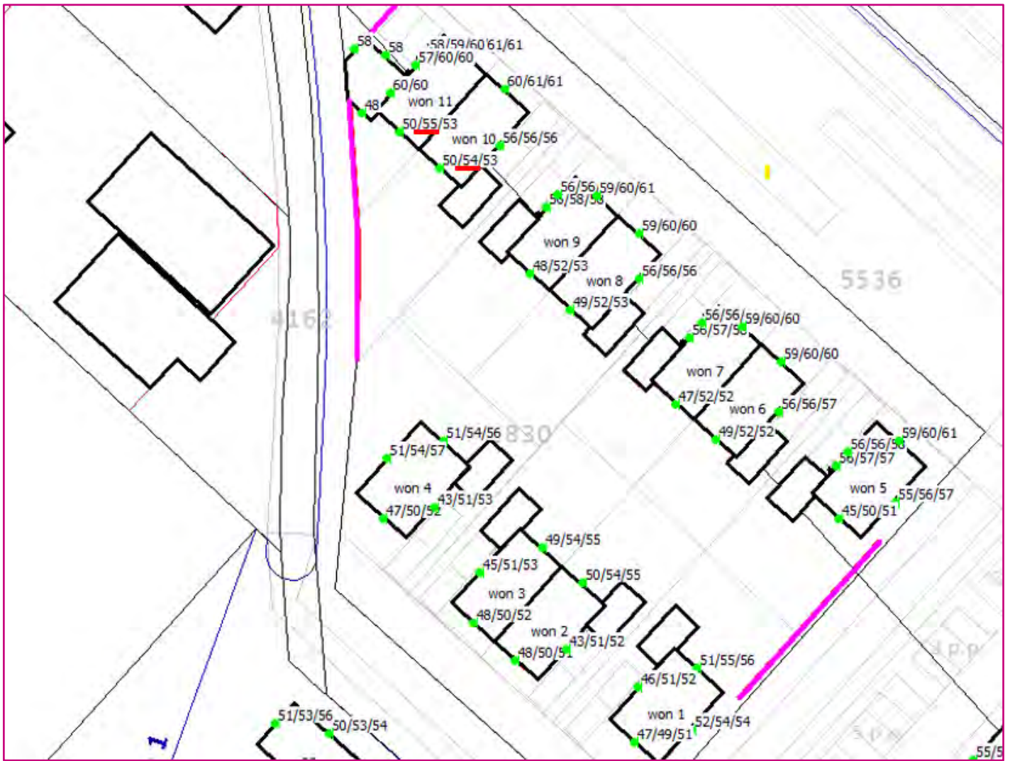
Figuur 5.15 Gecumuleerde geluidbelasting alle wegen samen, exclusief aftrek artikel 110g Wgh, bouwvlak 1
