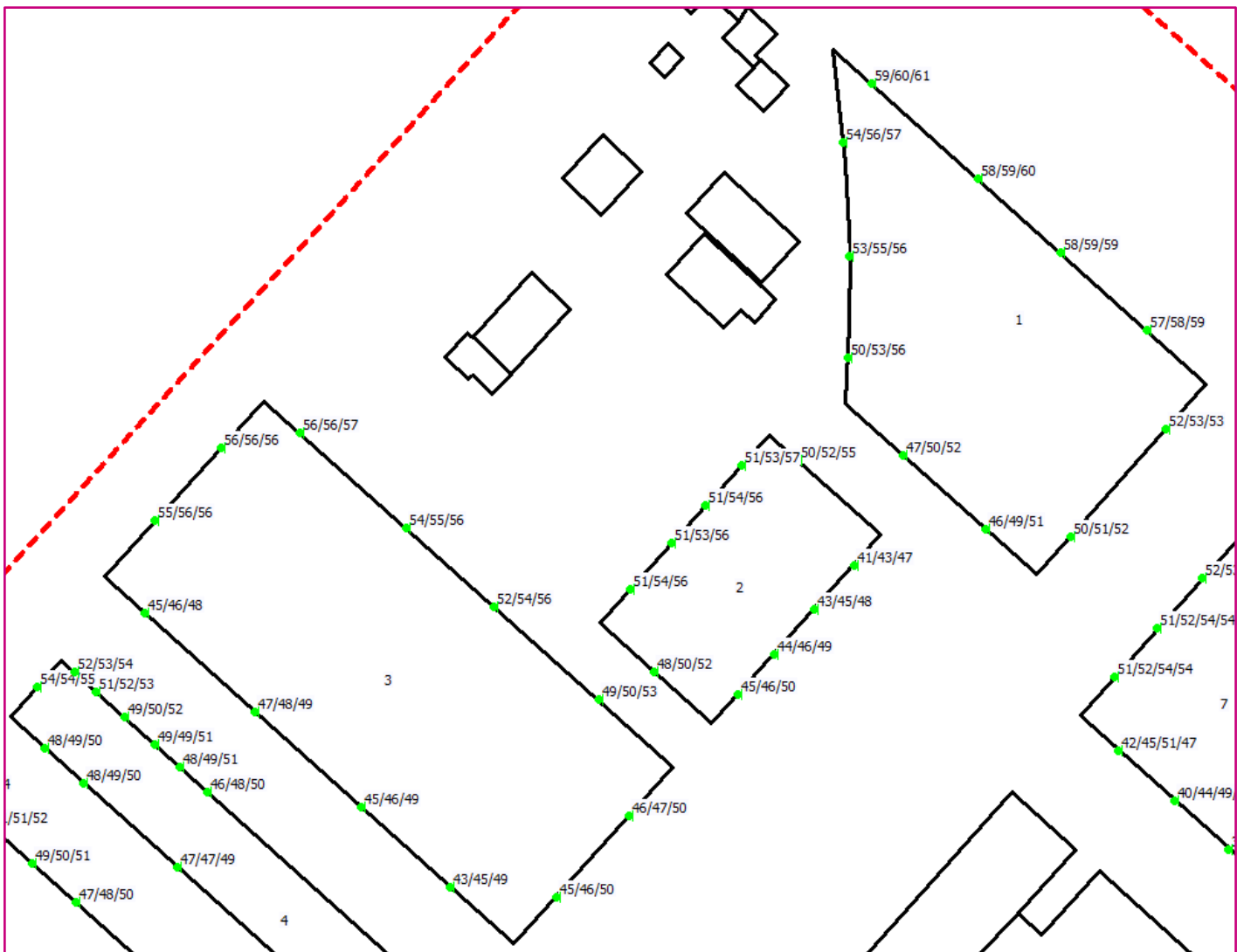
Figuur 5.1 Geluidbelasting vanwege N59 L_{den} in dB exclusief aftrek artikel 110g Wgh, bouwvlakken 1 t/m 3
