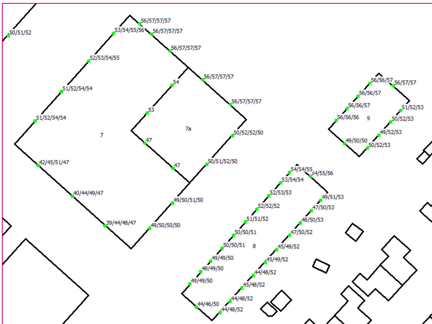
Figuur 5.2 Geluidbelasting vanwege N59 L den in dB exclusief aftrek artikel 110g Wgh, bouwvlakken 7 t/m 9
