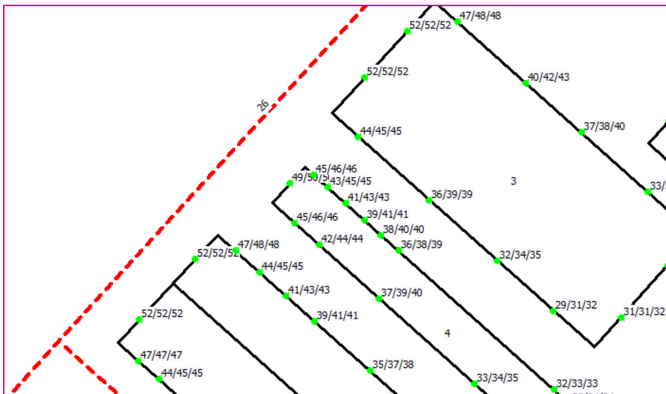
Figuur 5.10 Geluidbelasting vanwege Capelleweg inclusief aftrek, met SMA-NL8 G+, bouwvlakken 3 t/m 6
