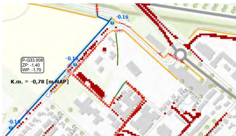
Figuur 1: Locatie ontwikkeling, nabij Capelleweg te Oude-Tonge. Aanvullend weergegeven zijn modelresultaten uit een grove analyse op hoofdwatgangniveau in de periode 2016-2020; T=100-peilstijgingen reiken tot -0,16mNAP en het kritisch maaiveld is -0,78mNAP. In rood zijn T=100-knelpunten weergegeven.
