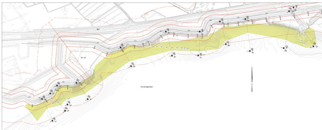
Figuur 1.2 Te bestorten dijktaalud in de Grevelingen, geel gemarkeerd is het gebied waar de vooroeverbrestortingen gepland staan
