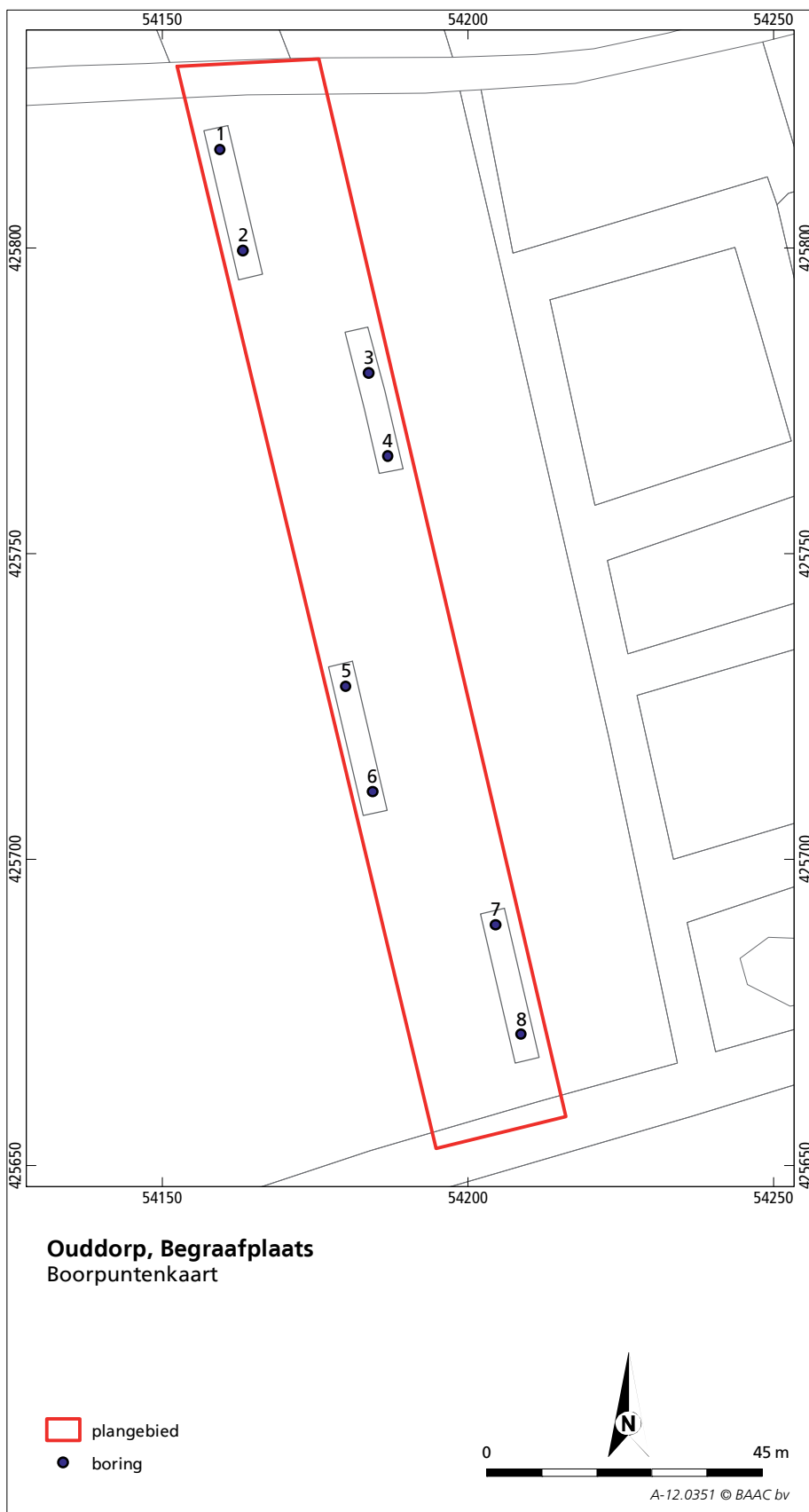
Afb. 3.01 Locatie van de boringen.8
