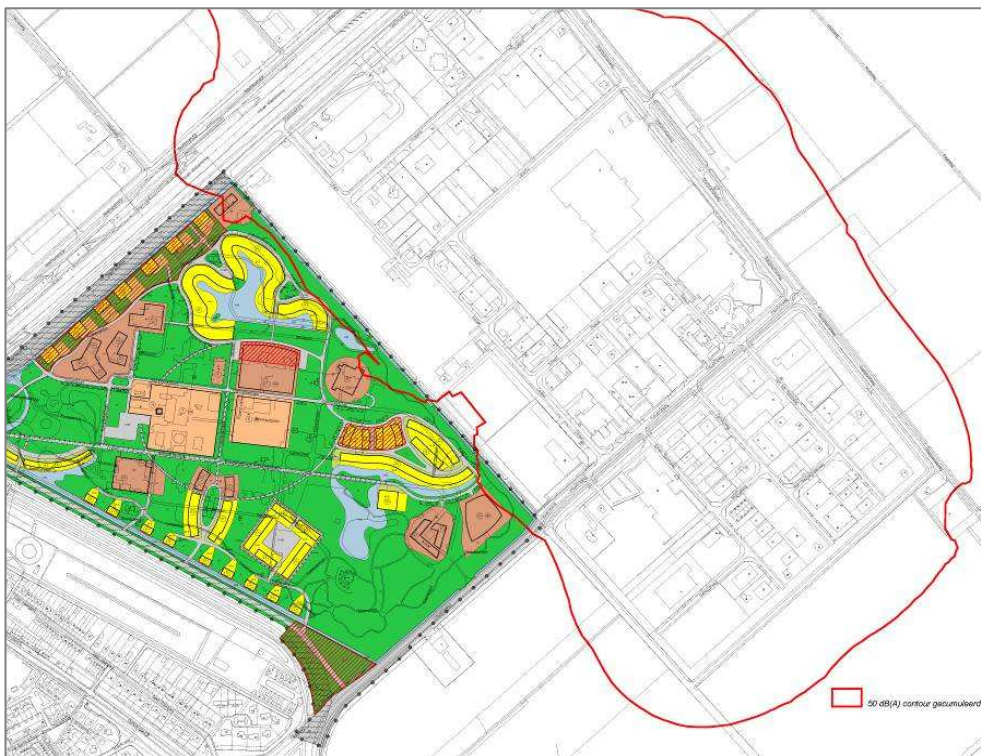
Gecumuleerde geluidbelasting (50 dB(A) geluidcontour) van de toegestane activiteiten van de bedrijven op Oostplaat in relatie tot Hernesseroord
