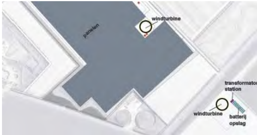
Figuur 3.4 Locatie transformatorgebouw en batterijopslag (bron: Landschappelijke inpassing zonneweide Van Pallandtpolder)
