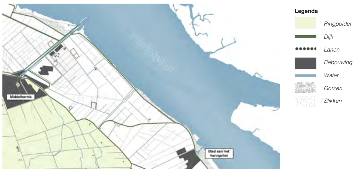
2015: stedelijke uitbreiding in de polder en vereenvoudigingen van het kavelpatroon en kavelrichting.
