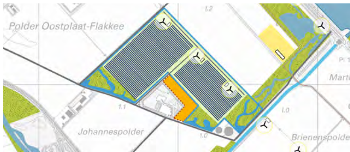
Alternatieve opstelling voor de zonnepanelen: volgen van de polderrichting, waardoor een zuidwest opstelling ontstaat.
