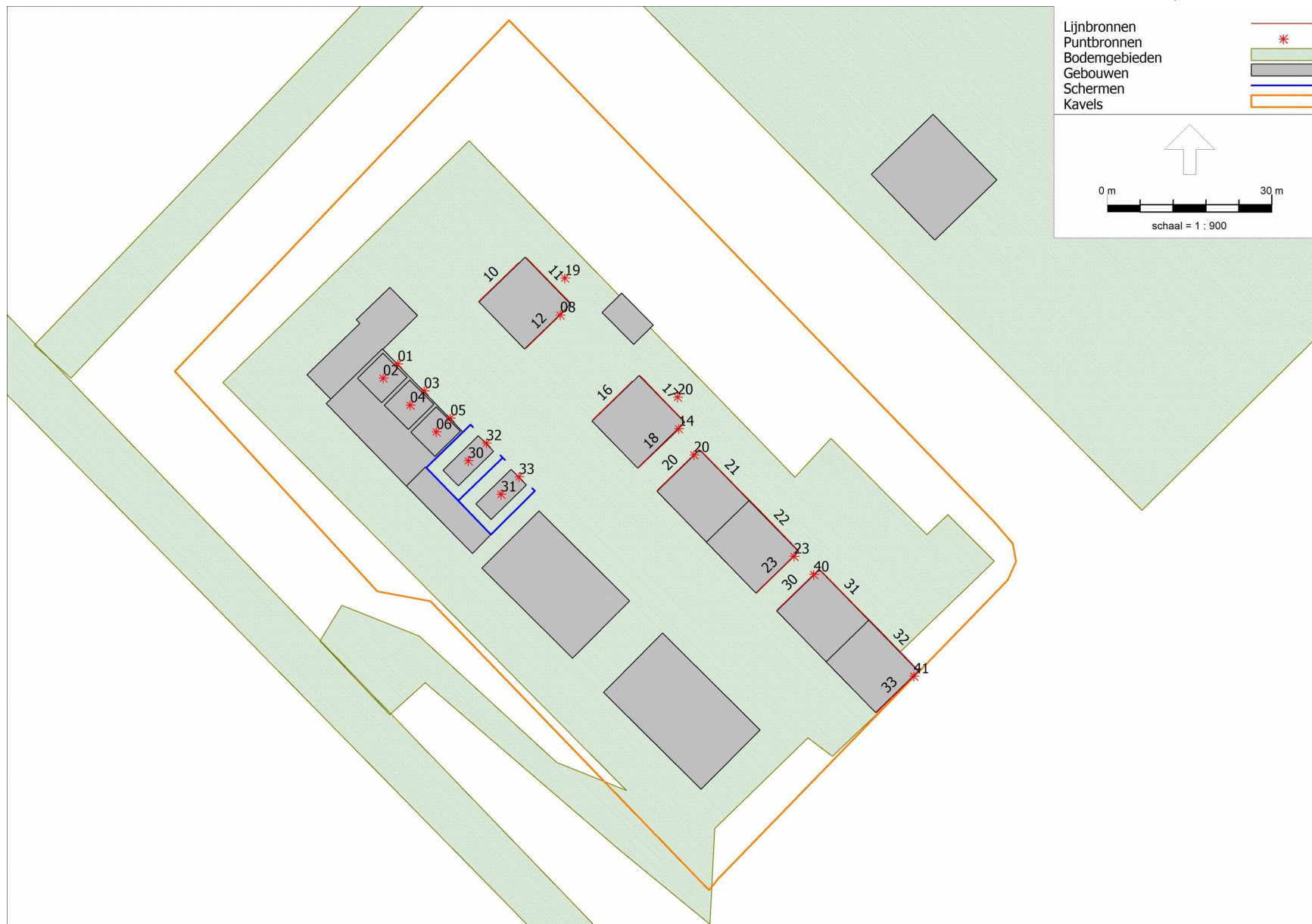
Figuur 1.3 puntbronnen en lijnbronnen op transformatorstation
