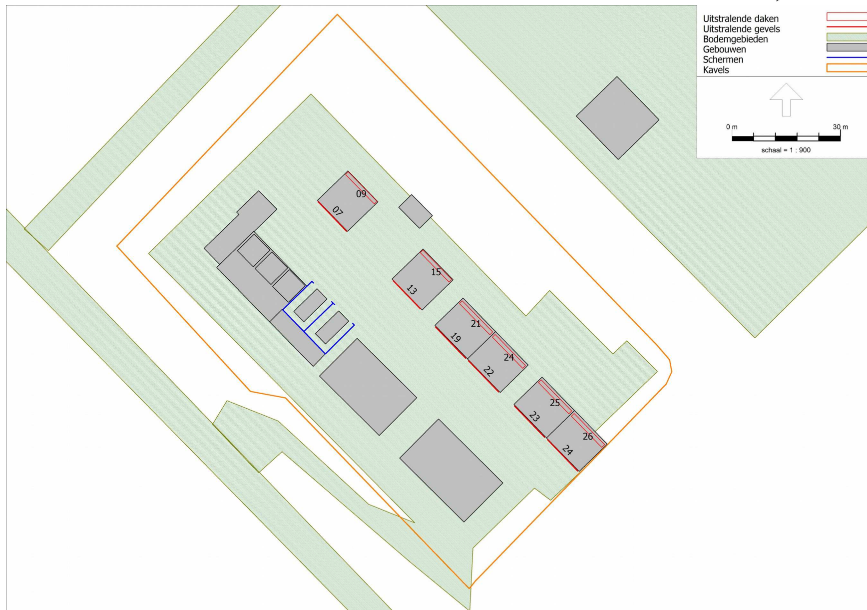
Figuur 1.4 uitstralende daken en gevels op transformatorstation
