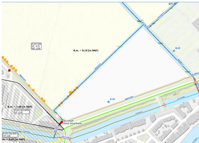
Afbeelding 2: Locatie ontwikkeling project LOO. Aanvullend weergegeven zijn modelresultaten uit een grove analyse op hoofdwatgangsniveau in de periode 2016-2020; T=100-peilstijgingen reiken tot 0,24mNAP en het kritisch maaiveld is 0,18mNAP.
