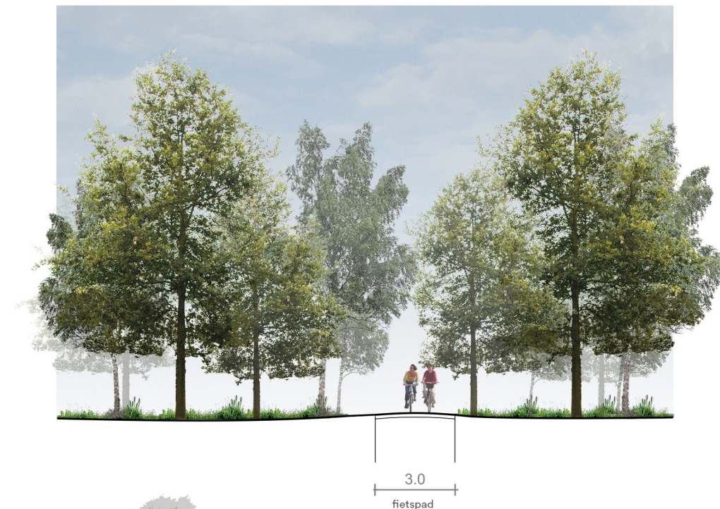
principeprofiel langzaam verkeer - fietspad
