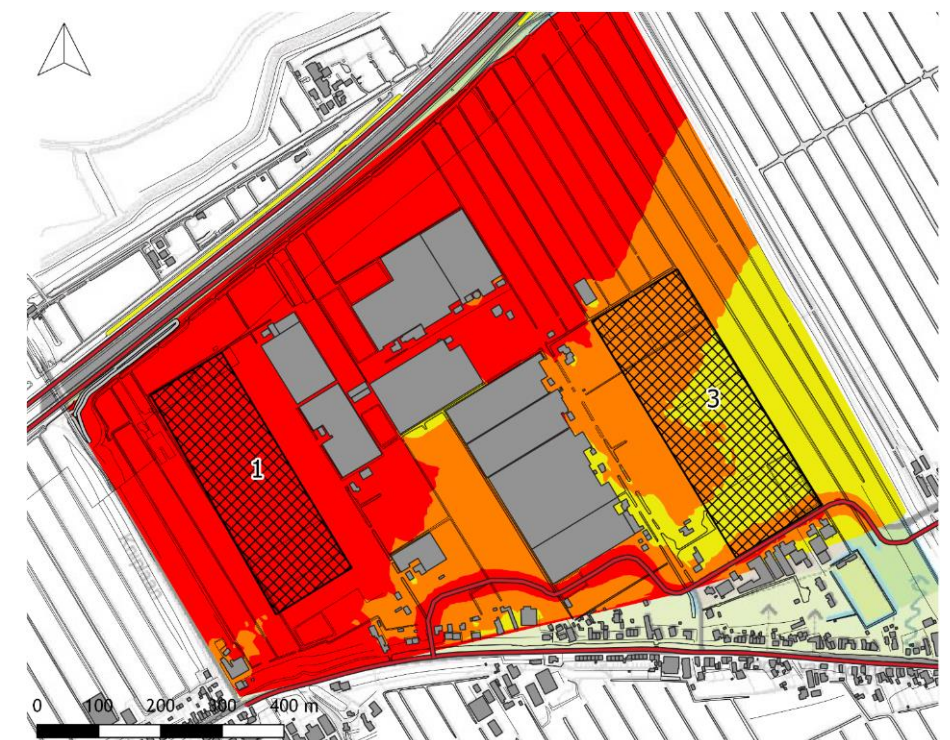
Figuur 12: geluidscontour 7,5 meter hoogte, zonder scherm en bestaande eerstelijns bebouwing
