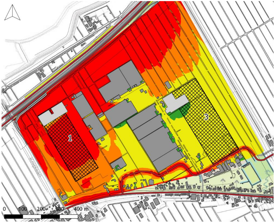
Figuur 3: geluidscontour 1,5 meter hoogte, zonder scherm met bestaande eerstelijns bebouwing
