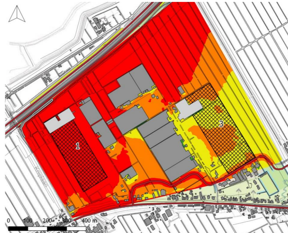
Figuur 5: geluidscontour 4,5 meter hoogte, zonder scherm met bestaande eerstelijns bebouwing
