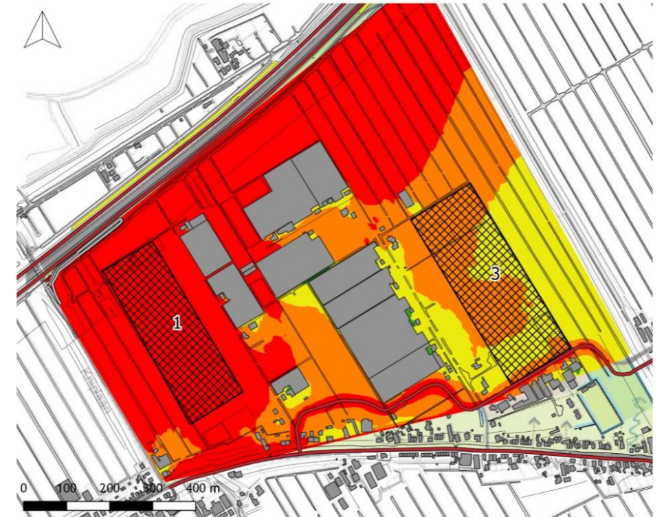
Figuur 6: geluidscontour 4,5 meter hoogte, zonder scherm en bestaande eerstelijns bebouwing
