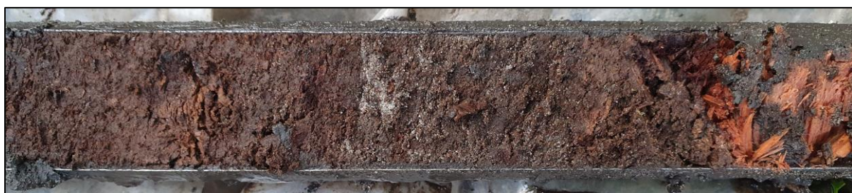
Boring 9. Onderste foto: Detail instuiving in veen
