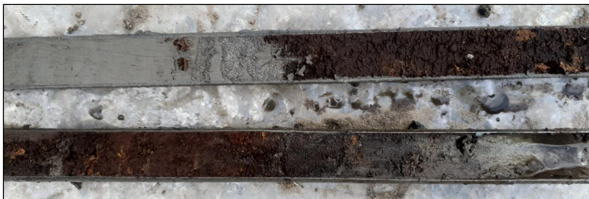
Boring 16. Onderste foto: Detail erosieve grens geulafzettingen/veen (bovenste guts) en niveau in top strandwal (onderste guts)
